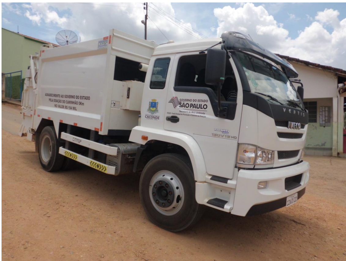
Figura 37: Caminhão compactador com capacidade para 4t.
