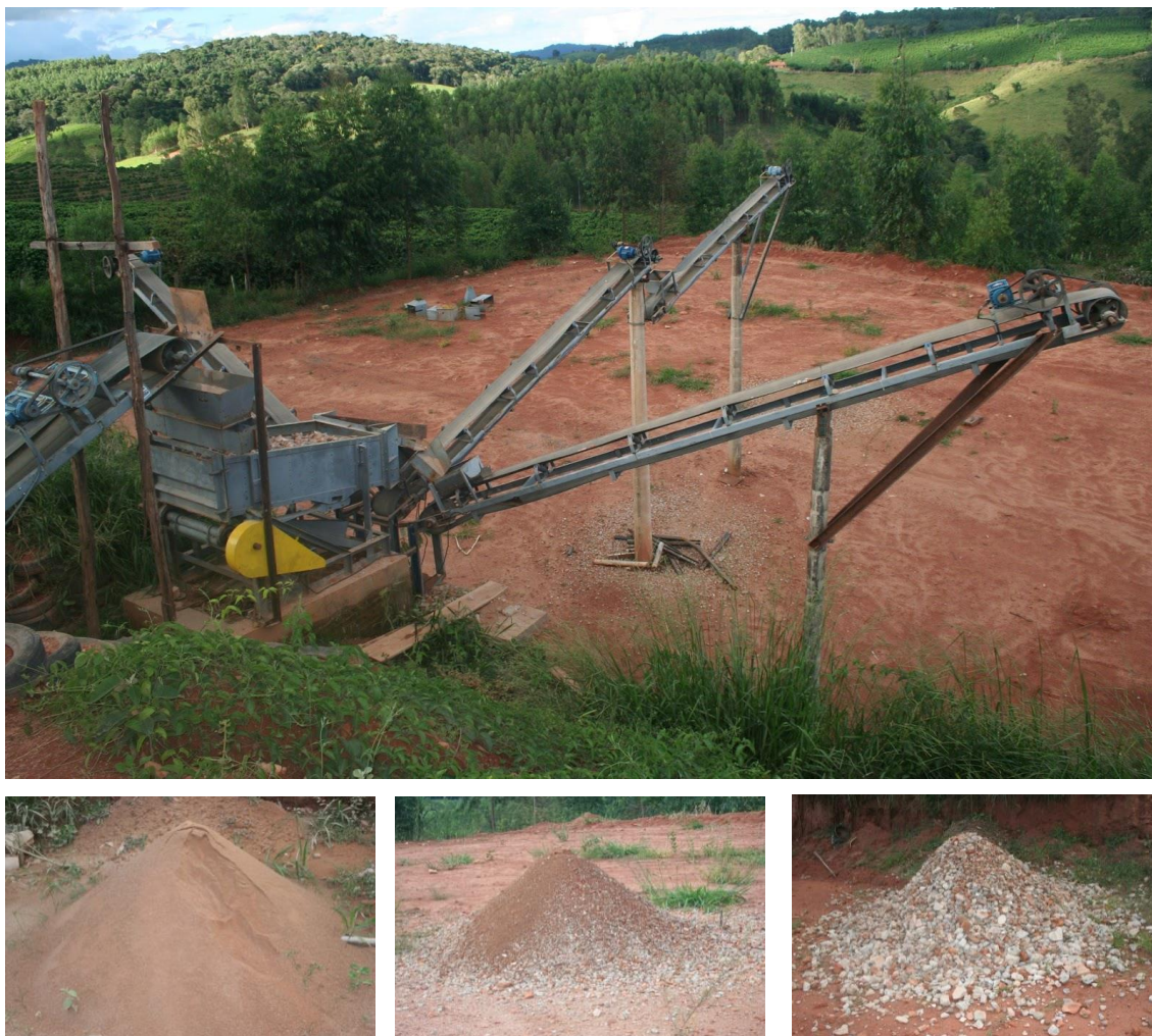
Figura 46: Esteiras de separação e tipos de areias produzidas.
