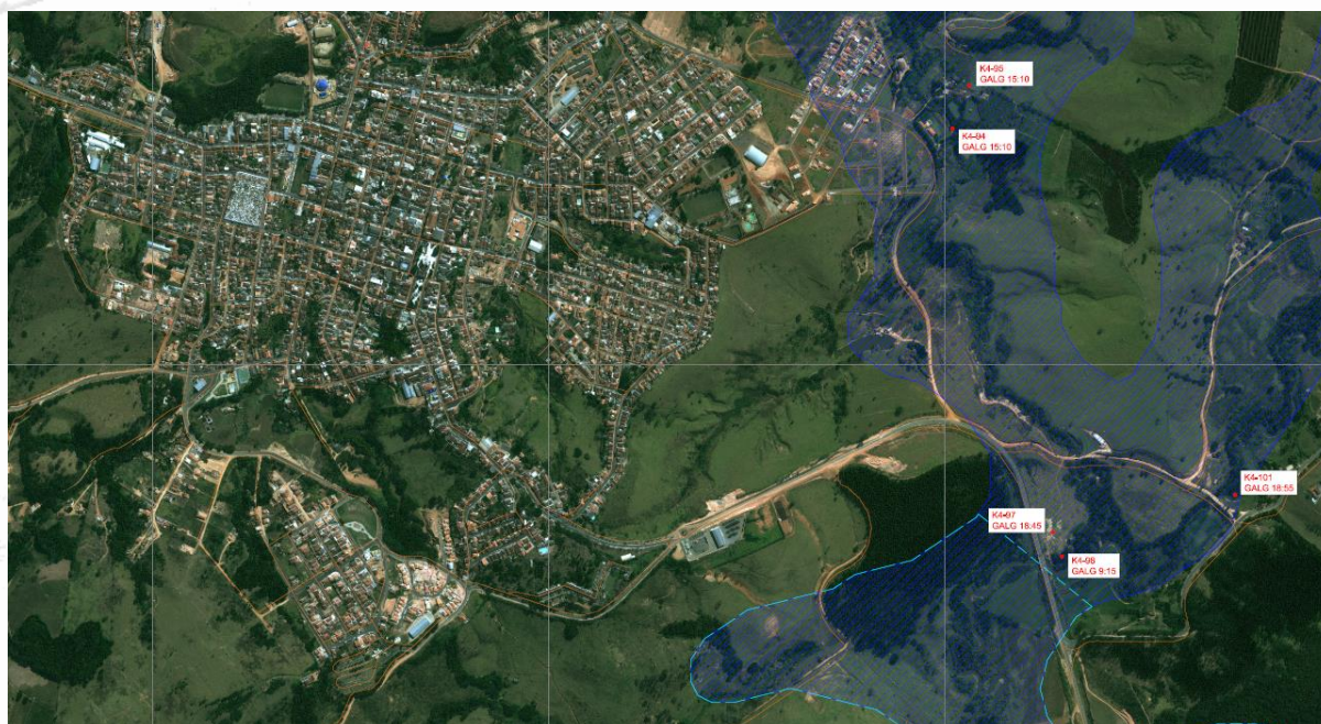
Mancha de inundação por Galgamento da Represa (AES, 2017)
