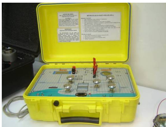
Figura 82. Equipamento que contém um sensor de diferencial de pressão
