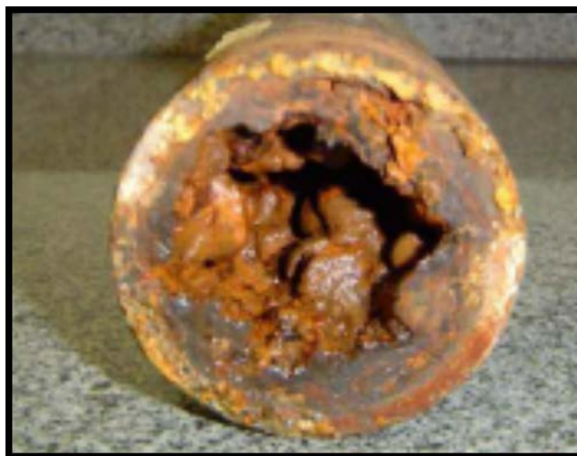
Figura 118: Ilustração de uma tubulação com secção incrustada
