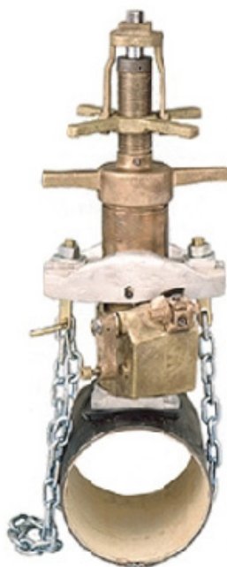
Figura 71. Máquina Miller instalada em uma tubulação
