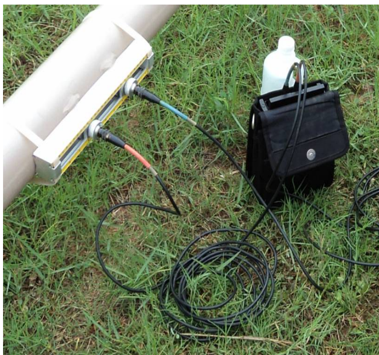
Figura 65. Ilustração da conexão entre os transdutores e a Unidade Eletrônica
