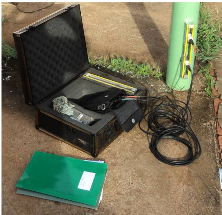
Figura 61. Ilustração do Medidor ultrassônico
