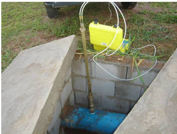
Figura 80. Tubo Pitot inserido em uma tubulação e conectado a um equipamento que contém um sensor de diferencial de pressão
