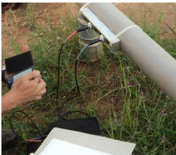
Figura 62. Ilustração da comunicação entre o Palm e Unidade Eletrônica
