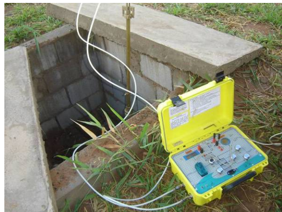
Figura 81. Tubo Pitot inserido em uma tubulação e conectado a um equipamento que contém um sensor de diferencial de pressão
